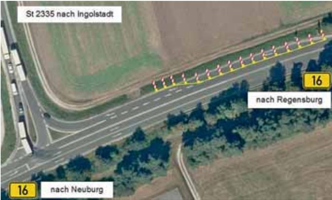
Abbildung: Durch das Leitelement, das nicht überfahren werden kann, wird die Rechtsausfädelungsspur der B 16 verkürzt. Die Sichtverhältnisse für die Linkseinbieger, die von der St 2335 in die B 16 einbiegen wollen, werden dadurch verbessert.
